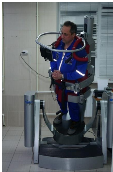
Рис. Исследование функционального состояния опорно-двигательного аппарата космонавта на роботизированном биомеханическом комплексе Centaur
